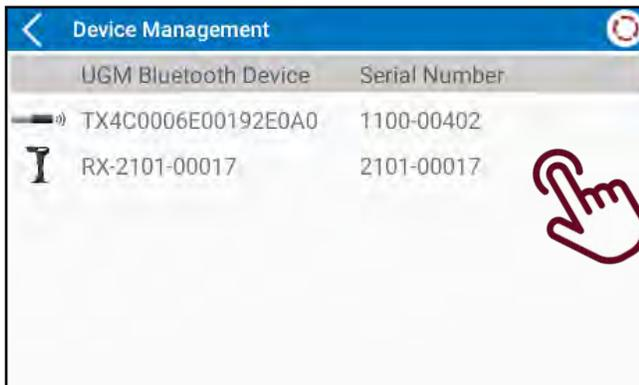
En esta página vemos los dispositivos conectados disponibles. En el ejemplo de arriba se muestran el Transmisor y el Receptor conectados y sus números de serie correspondientes. Para desbloquear un dispositivo selecciones el dispositivo para pasar a la siguiente pantalla.
