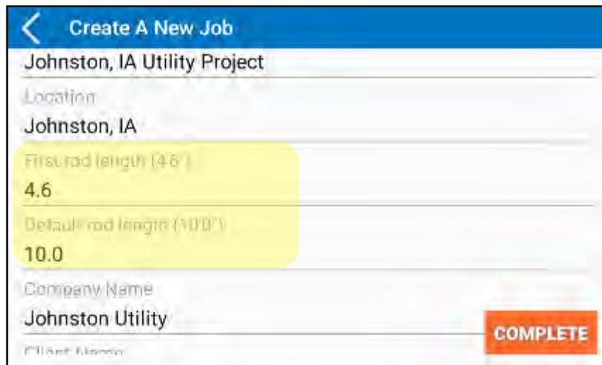
Cuando se crea un nuevo perfil de trabajo, las longitudes de la varilla se deben ingresar con exactitud a fin de lograr precisión en los datos.
